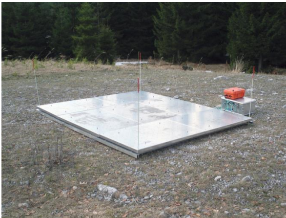
Schneewaage SSG (Sommer) an der Wewa Wasserkuppe (Quelle: G. Schneider)
